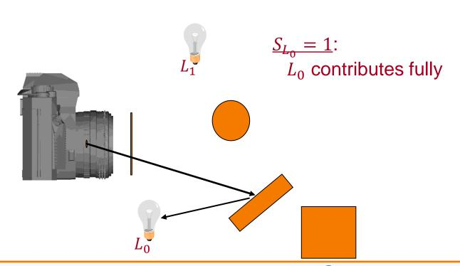
$$I = I_E + \sum_{l} \left[ K_A \cdot I_L^A + \left( K_D \cdot \langle \vec{N}, \vec{L} \rangle + K_S \cdot \langle \vec{V}, \vec{R} \rangle^n \right) \cdot I_L \left( S_L \right) + K_S \cdot I_R + K_T \cdot I_T \right]$$
