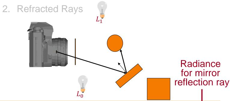
$$I = I_E + \sum \left[ K_A \cdot I_L^A + \left( K_D \cdot \langle \vec{N}, \vec{L} \rangle + K_S \cdot \langle \vec{V}, \vec{R} \rangle^n \right) \cdot I_L \cdot S_L \right] + K_S \cdot I_R$$
