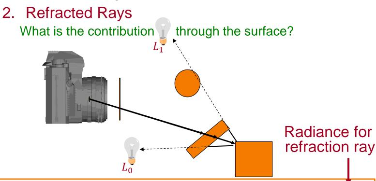
$$I = I_E + \sum_{i} \left[ K_A \cdot I_L^A + \left( K_D \cdot \langle \vec{N}, \vec{L} \rangle + K_S \cdot \langle \vec{V}, \vec{R} \rangle^n \right) \cdot I_L \cdot S_L \right] + K_S \cdot I_R + K_T \cdot I_T$$
