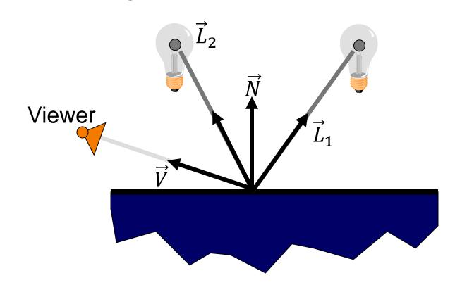
$$I = I_E + \sum_{\vec{l}} \left[ K_A \cdot I_L^A + \left( K_D \cdot \langle \vec{N}, \vec{L} \rangle + K_S \cdot \langle \vec{V}, \vec{R} \rangle^n \right) \cdot I_L \right]$$
