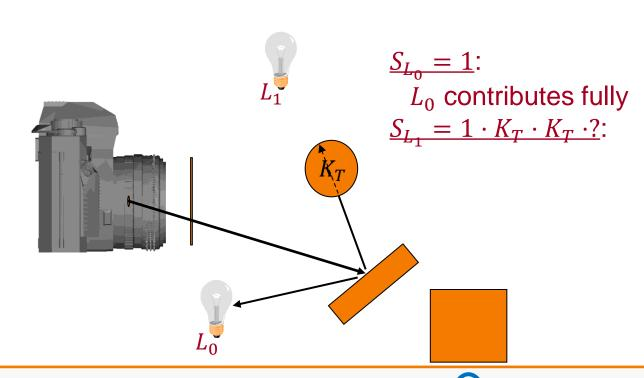
$$I = I_E + \sum_{\vec{l}} \left[ K_A \cdot I_L^A + \left( K_D \cdot \langle \vec{N}, \vec{L} \rangle + K_S \cdot \langle \vec{V}, \vec{R} \rangle^n \right) \cdot I_L \left( S_L \right) + K_S \cdot I_R + K_T \cdot I_T \right]$$
