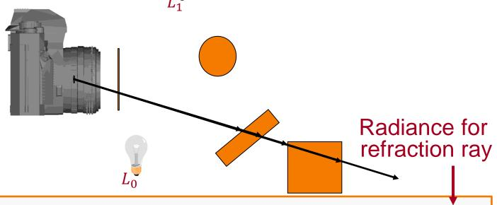
$$I = I_E + \sum \left[ K_A \cdot I_L^A + \left( K_D \cdot \langle \vec{N}, \vec{L} \rangle + K_S \cdot \langle \vec{V}, \vec{R} \rangle^n \right) \cdot I_L \cdot S_L \right] + K_S \cdot I_R + K_T \cdot I_T$$
