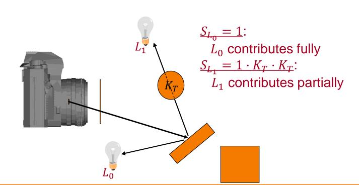
$$I = I_E + \sum_{l} \left[ K_A \cdot I_L^A + \left( K_D \cdot \langle \vec{N}, \vec{L} \rangle + K_S \cdot \langle \vec{V}, \vec{R} \rangle^n \right) \cdot I_L \left( S_L \right) + K_S \cdot I_R + K_T \cdot I_T \right]$$
