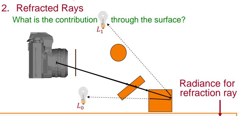
$$I = I_E + \sum_{\vec{l}} \left[ K_A \cdot I_L^A + \left( K_D \cdot \langle \vec{N}, \vec{L} \rangle + K_S \cdot \langle \vec{V}, \vec{R} \rangle^n \right) \cdot I_L \cdot S_L \right] + K_S \cdot I_R + K_T \cdot I_T$$
